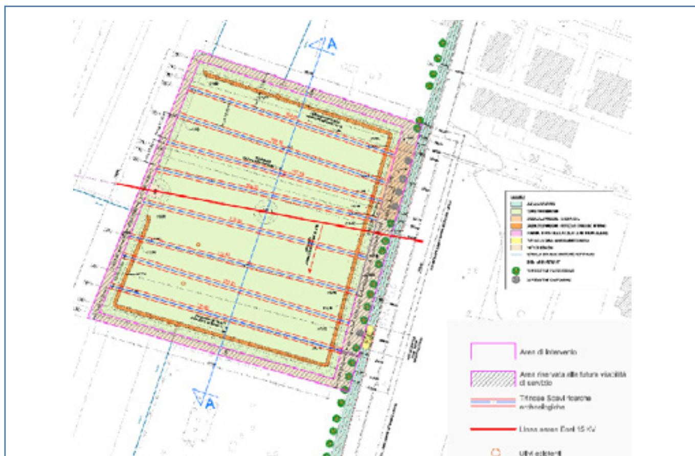
Estratto tavola tecnica del progetto esecutivo con la localizzazione delle trincee
